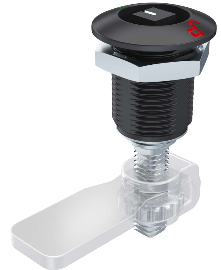
Durch die 90° Drehung der Betätigung wird die Zunge hinter die Schließfläche gedreht, die Tür kann nicht mehr geöffnet werden
